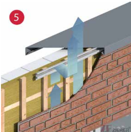
Oberer Abschluss zum Dachanschluss, Dachschräge (Entlüftung).
