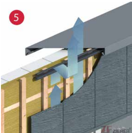
Oberer Abschluss zum Dachanschluss, Dachschräge (Entlüftung).
