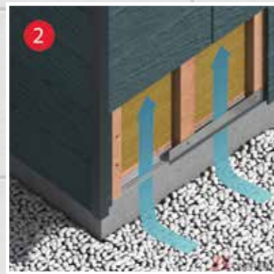
2 Starterleiste / Lüftungswinkel starting profile / ventilation profile
